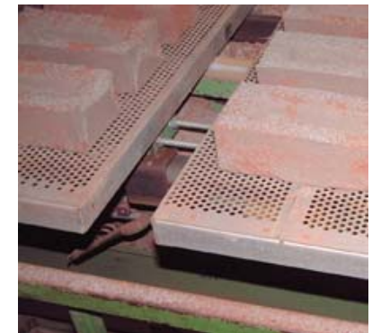
Lochbleche für Trocknung
